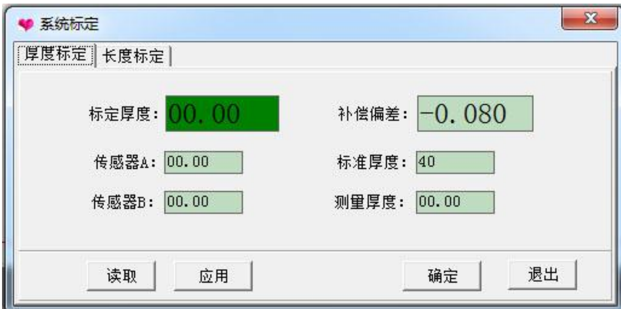
上图为传感器精度补偿标定对话框，用来标定系统测厚精度的标定
