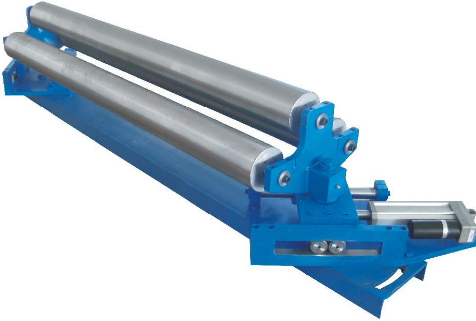
三辊纠偏导向架 型号：KJ-1800-Y-3
